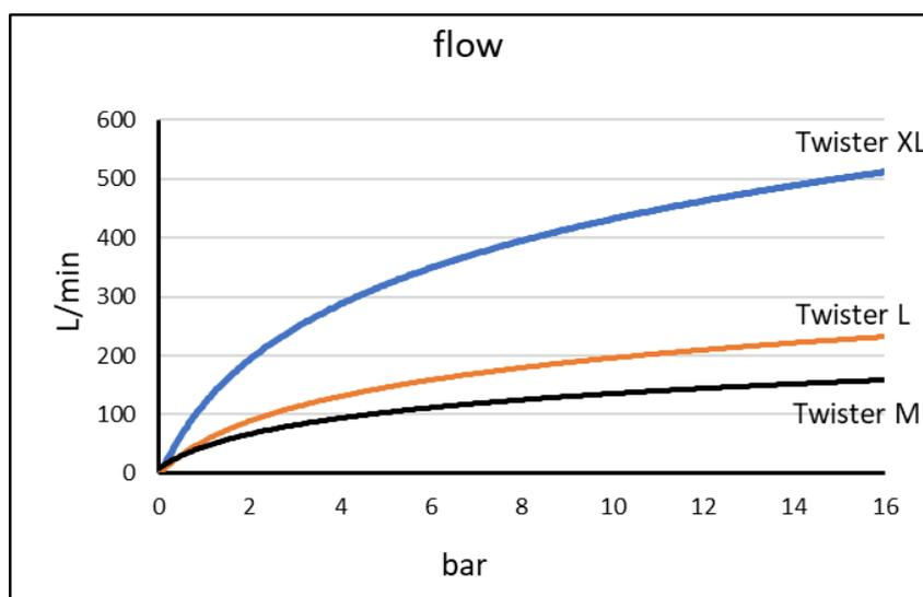
Wasserdurchfluss in L/min bei voll geöffneter Düse, abhängig vom Druck
